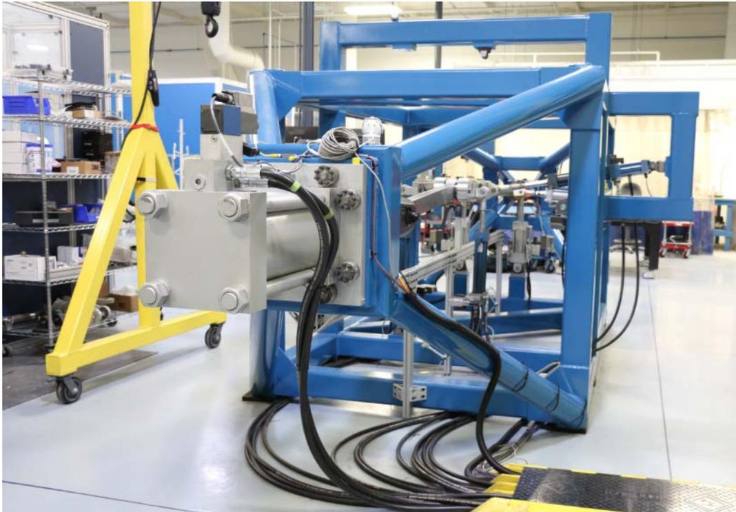
*Image 3: Horizontal fatigue test frame*
